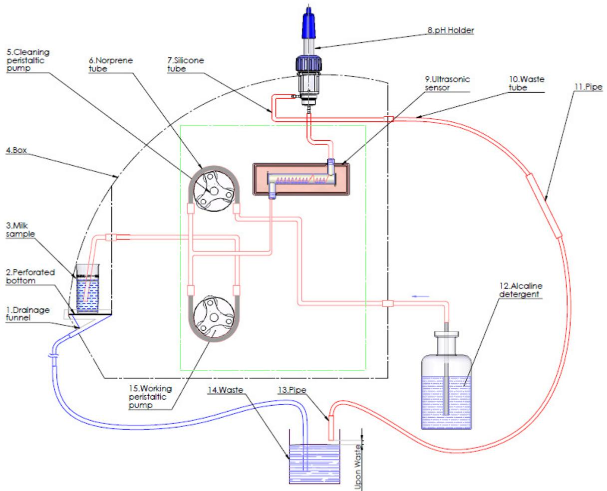
**Fig. 4 Conexión de dispositivos periféricos**
